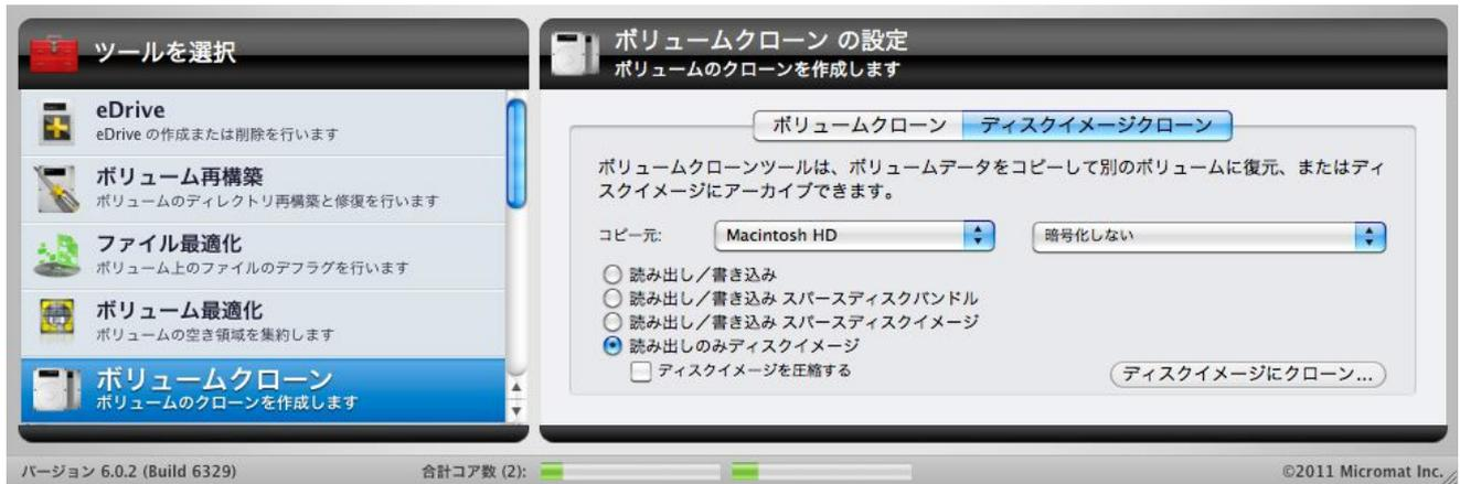
ディスクイメージクローンを作成するには、コピー元を選択して、ディスクイメージの種類を選択します。[ディスクイメージにクローン...] をクリックすると、ダイアログボックスが表示され、ディスクイメージを保存する場所を指定します。その後、TechTool Pro はコピー元ドライブの内容を .dmg ファイルにコピーします。作成された .dmg ファイルをダブルクリックすると、イメージがマウントされ、ファイルやフォルダなどにアクセスできるようになります。
