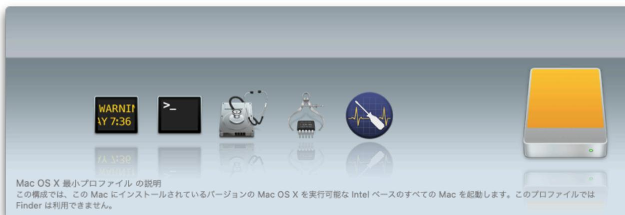
プロフィールビューアの左上に選択しているプロフィールに含まれる Mac OS の種類がアイコンで表示されます。その下に、プロフィールに含まれるユーティリティのアイコンが表示されます。ビューア下部には、プロフィール名とそのプロフィール説明の冒頭部分が表示されます。プロフィールについての詳細を確認するには、
