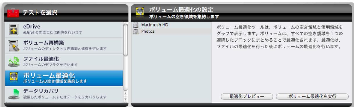
左側のボリュームリストから検査または最適化するボリュームを選択します。[最適化プレビュー] ボタンをクリックすると、ステージにボリュームの情報と使用状況がグラフで表示されます。
