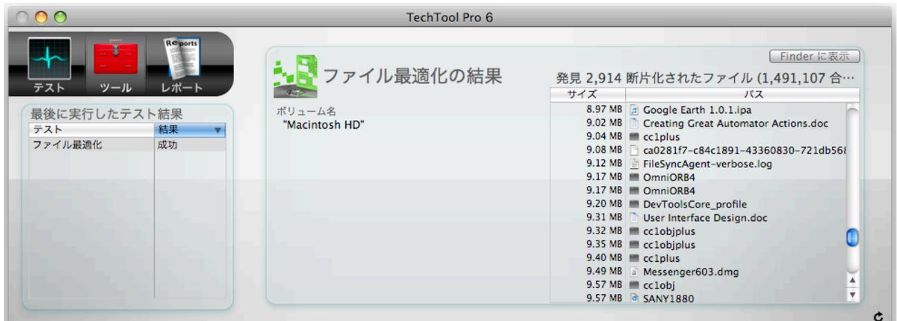
[ファイルの最適化を実行] ボタンをクリックすると、選択されているボリュームの断片化されたファイルの再配置を行います。再配置中の進行状況がステージに表示されます。
