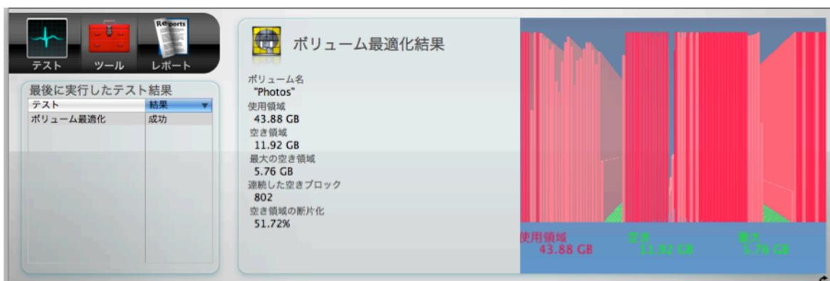
[ボリューム最適化を実行] ボタンをクリックして、選択されたボリュームの最適化を実行します。空き領域が再配置される進行状況がステージに表示されます。
