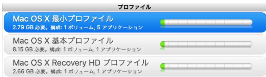
プロファイルはデバイス全体の構成を定義するファイルです。プロファイルペインにはあらかじめ定義されているデフォルトプロファイルと、ユーザが独自に定義したカスタムプロファイルの両方が表示されます。プロファイルは **4GB** の **USB** メモリや **iPod** 向けに最小限のシステムと数個のユーティリティで構成するものから、大容量ハードドライブ向けに **Mac OS** と複数のユーティリティや、その他のソフトウェアを含めたものまで、用途に応じて作成できます。
