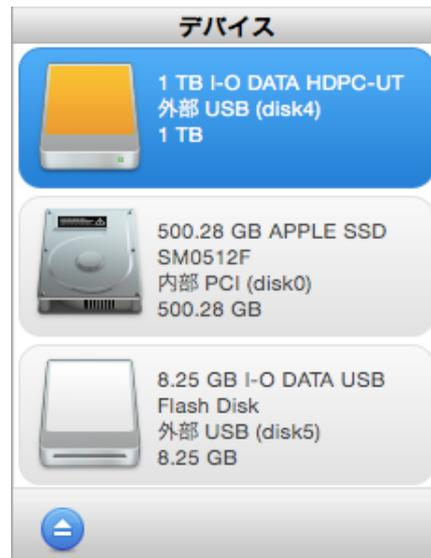
使用するデバイスを選択するには、デバイスのアイコンをクリックします。アイコンの右側にはデバイス名、デバイスの種類、識別子 (外部 FireWire (disk1) など)、サイズが表示されます。デバイス情報の下にある [取り出し] ボタンをクリックすると、選択したデバイスを取り出すことができます。
