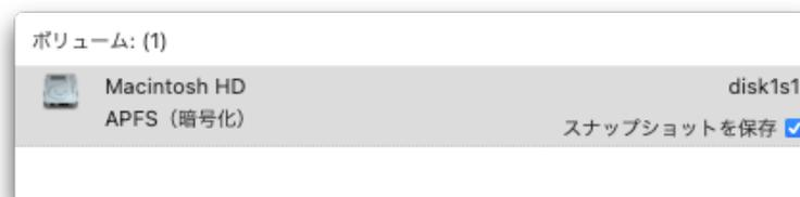
TechTool Pro のスナップショットは、ボリュームリストで選択したボリュームに従って一覧表示されます。ボリュームのスナップショットを無効にすると、既存のスナップショットは作成から4日後に自動的に削除されます。または、スナップショットテーブルの下部にあるマイナスボタンを使用して手動で削除することもできます。
